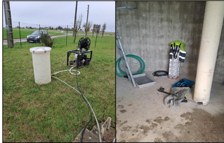
Equipements utilisés par la SAUR pour le lavage : pompe, karcher, désinfectant
